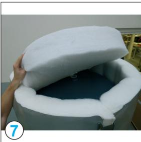
Deckelisolierung einlegen (Position der beiden Stützen beachten)
